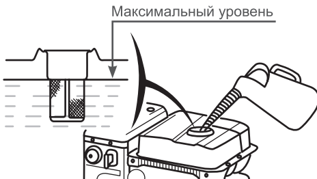
Рис. 4 Максимальный уровень топлива в топливном баке
